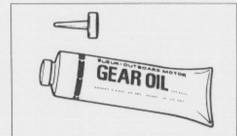
Utiliser de l'huile SUZUKI OUTBOARD MOTOR GEAR OIL ou une huile équivalente SAE90 de bonne qualité pour engrenages hypoides.
